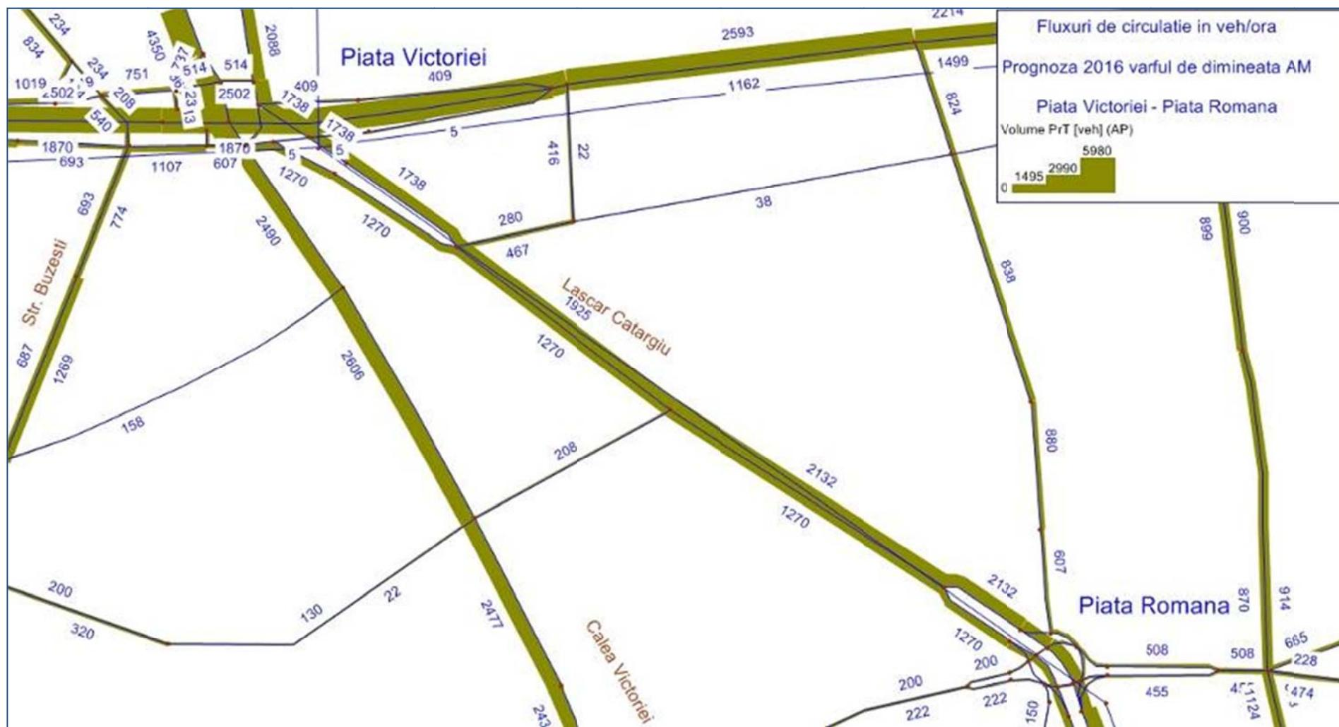
Figura 50: Fluxurile de circulație în Vehicule/oră, ora de vârf de dimineață AM - București, anul 2016 - Piața Română
