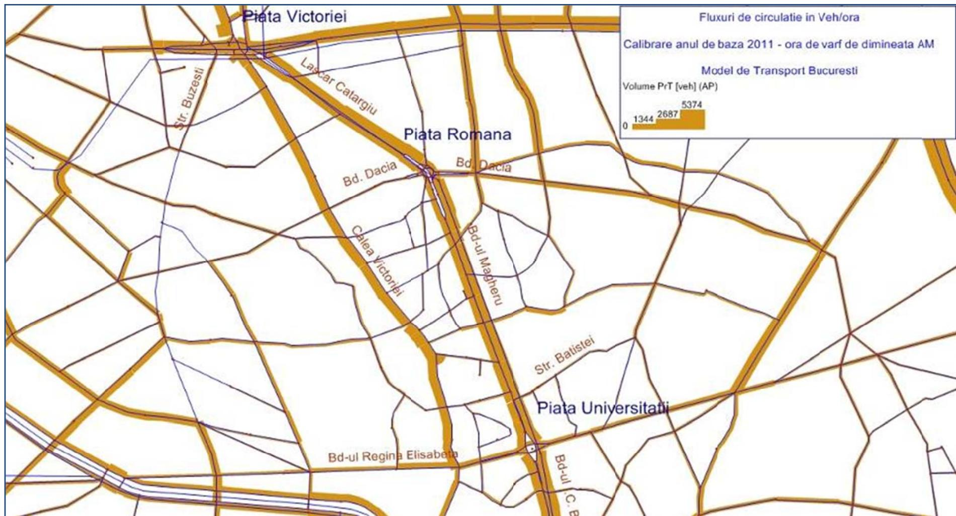
**Figura 17: Fluxurile de circulație în Vehicule/oră, ora de vârf de dimineață AM - București, anul de bază 2011 - Piața Victoriei**
