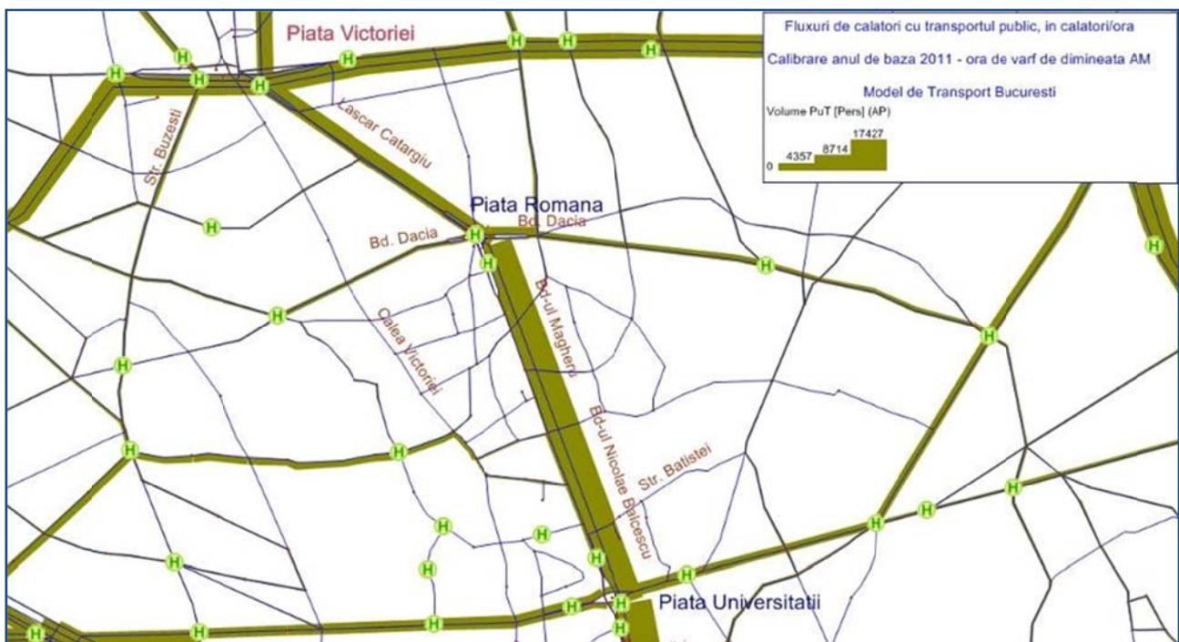
**Figura 47: Fluxurile de circulație cu transportul public, în călători/oră, ora de vârf de dimineață AM, anul de bază 2011**
