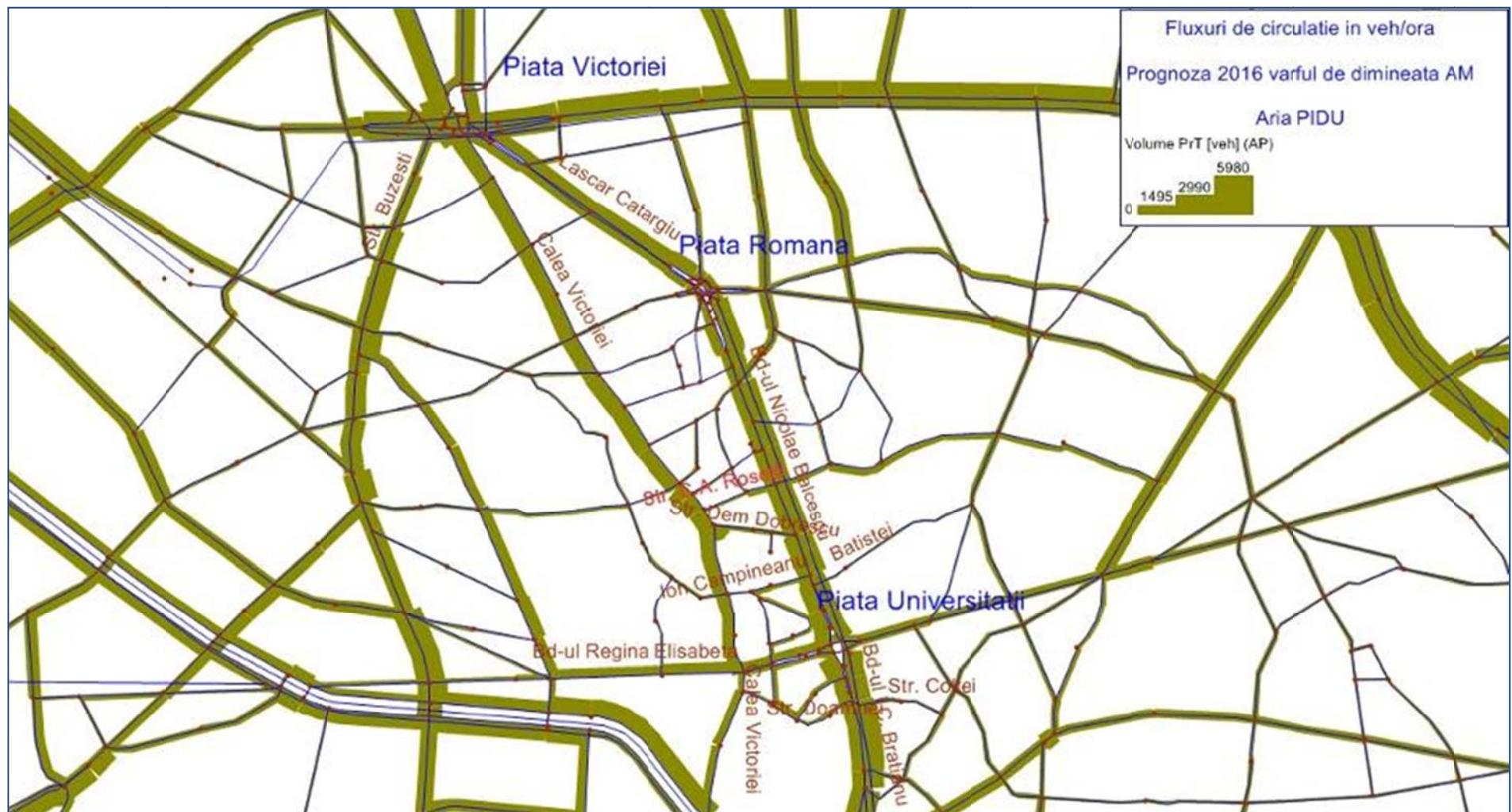
Figura 48: Fluxurile de circulație în Vehicule/oră, ora de vârf de dimineață AM - București, anul 2016 - Piața Victoriei
